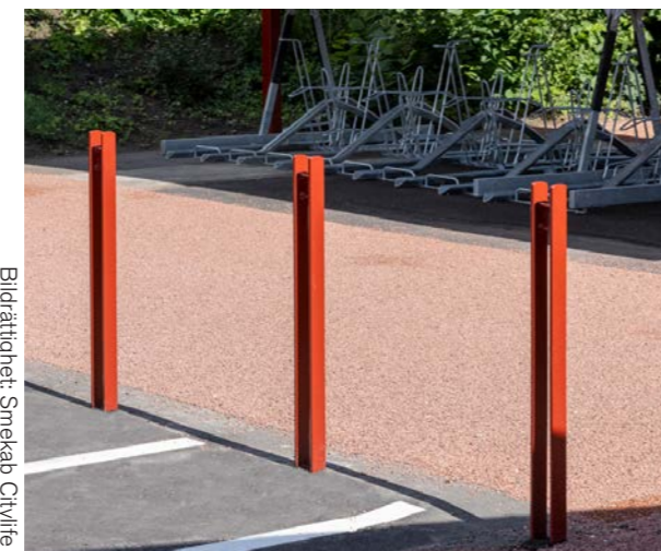
U7- Silhuet från Hitsa, cykelpollare. Vänds med plattstålet frammåt för att stoppa att cyklister placerar cykelns däck i pollaren, detta gör att det finns plats att låsa fast sin cykel i ramen från båda sidorna.
